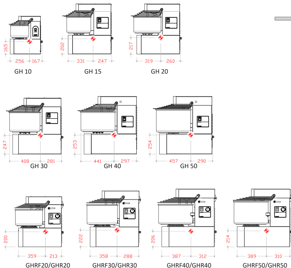
Fig. 3.9.2. - Centro de gravedad de la máquina
